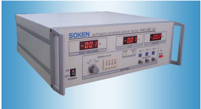
测试主机 DAC-ASC-2C
