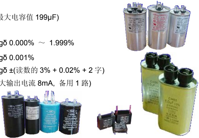
各种 CBB 及 BCMJ 薄膜电容器试品
